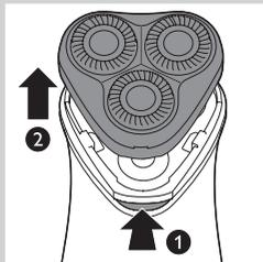
Az optimális borotválás érdekében két évente cserélje ki a körkéseket. A sérült vagy kopott borotvafejeket kizárólag HQ56 Philips borotvafejekre cserélje.
