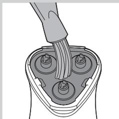
**4** Oczyszć szczoteczką wewnątrz elementu golącego oraz komorę na włosy.
