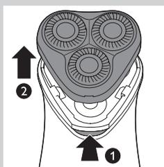
Для достижения оптимальных результатов бритья производите замену бритвенных головок каждые два года. Поврежденные или изношенные бритвенные головки следует заменять только бритвенными головками Philips HQ56.
