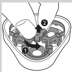
**3** Kolieskom otočte proti smeru pohybu hodinových ručičiek (1) a vyberte prítlačný rám (2).
