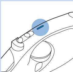
Благодаря функции автоворыключения утюг отключается автоматически, если не используется более 30 секунд (в горизонтальном положении) или более 8 минут (в вертикальном положении). Загорается индикатор автоворыключения.
