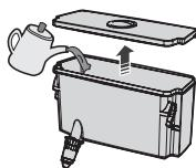
**ЗАСТЕРЕЖЕННЯ** При зборці ємності для води після очищення перевірте, щоб краник кулера був зібраний. Це може привести до витоку води.
