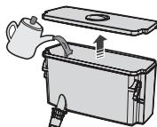
**ПРЕДОСТЕРЖЕНИЕ** При сборке емкости для воды после очистки проверьте, чтобы кранник кулера был собран. Это может привести к утечке воды.
