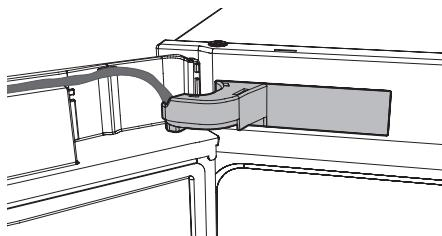
16. Измените направление дверцы проводов на противоположное и соберите крышку дверцы.
