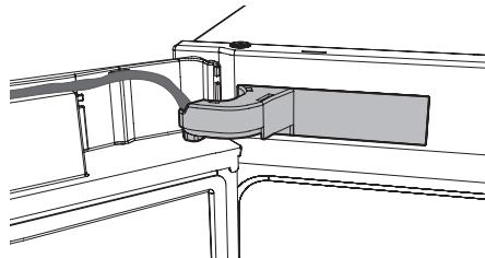
16. Змініть напрямок дверцят проводів на протилежний і зберігте кришку дверцят.
