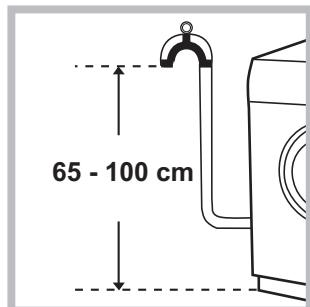
Підключіть зливний шланг, не згинаячи його, до каналізаційного каналу або до входу до такого каналу на стіні, на відстані від 65 до 100 см від підлоги;
