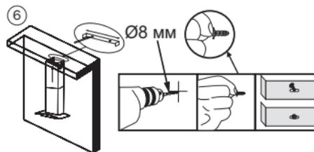
1. Прикрепите вытяжку задней поверхностью к стене при помощи саморезов с дюбелями из монтажного комплекта.
