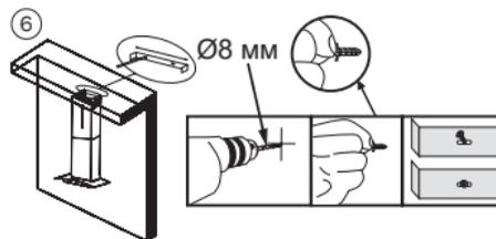
1. Прикріпіть витяжку задньою поверхнею до стіни за допомогою саморізів з дюбелями з монтажного комплекту.
