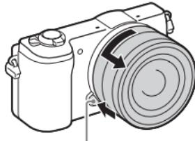
Кнопка отсоединения объектива
