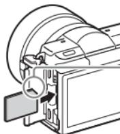
Kontrollera att det fasade hörnet är vänt på rätt håll.
