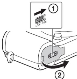
Leva di espulsione della batteria
