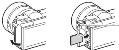
Auf korrekte Ausrichtung der eingekerbt Ecke achten.
