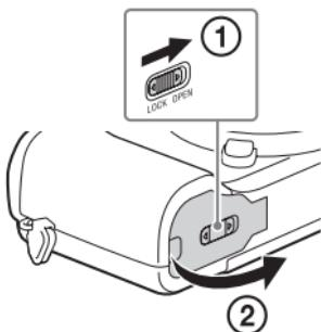
Palanca de expulsión de la batería
