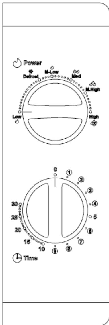
Панель управління складається з двох регуляторів функції. Одним з них є таймер ручка, а інший регулятор потужності.
