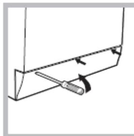
1. Снимите внешнюю панель на передней части стиральной машины при помощи отвертки (см.рисунок)
