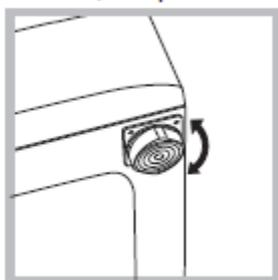
2. Если пол неидеально ровный, компенсируйте неровности при помощи передних ножек (см. рисунок) – раскручивая и закручивая их; угол наклона относительно рабочей поверхности не должен превышать 2°.
