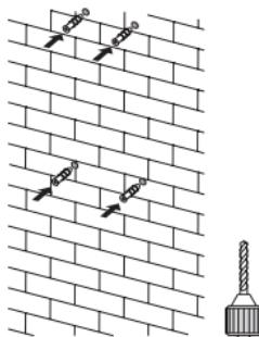
1. Прикрепите вытяжку зайдней поверхностью к стене при помощи саморезов с дюбелями из монтажного комплекта.
