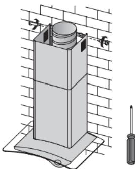
2. Соедините воздуховод с адаптером вытяжки. Выведите другой конец воздуховода в вентиляционную шахту. Убедитесь в отсутствии щелей в соединениях.
