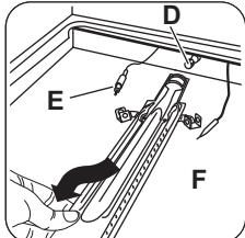
4. Плавно переместите ее влево. Убедитесь, что втулка горелки находится в сопле горелки. Не прилагайте усилия к проводу, идущему к разъему свечи зажигания (F) и к проводу термопары (Е).
