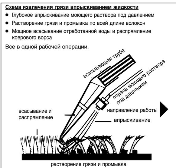
Нажать рычаг запорного клапана (24) до выхода моющей жидкости, а приложенную к коврам насадку провести прямой полосой по коврам. Количество распыляемой жидкости можно плавно регулировать колесиком, размещенным на рукоятке. В конце полосы или при перерыве отпустить рычаг клапана, чтобы остановить струйное распыление. После того как распыленная жидкость собрана, приподнять насадку и начать новую полосу с небольшим наложением на предыдущую. Так полосу за полосой можно обработать всю поверхность.
