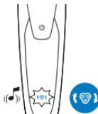
Пристрій обладнано нагадуванням про заміну бритвених головок. Коли потрібно замінити бритвені головки, символ бритвеного блока світиться безперервно, стрілки блимають білим світлом і лунає звуковий сигнал.
