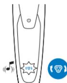
Нагадування про заміну вказує, що потрібно замінити бритвені головки. Коли Ви вимикаете бритву, символ бритвеного блока світиться безперервно, стрілки блимають білим і лунає звуковий сигнал.
