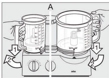
Затем следует повернуть емкость в направлении вращения до тех пор, пока будет достигнуто нижнее фиксированное положение. На другом приводном месте емкость должна находиться в поднятом положении. В том случае, когда другое приводное место свободно, следует установить на него защитный кожух <sup>13</sup>.
