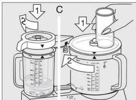
Затем поверните крышку по часовой стрелке, направляя ее носик в отверстие запора безопасности моторного блока <sup>①</sup> до тех пор, пока не будет слышен звук защелки.
