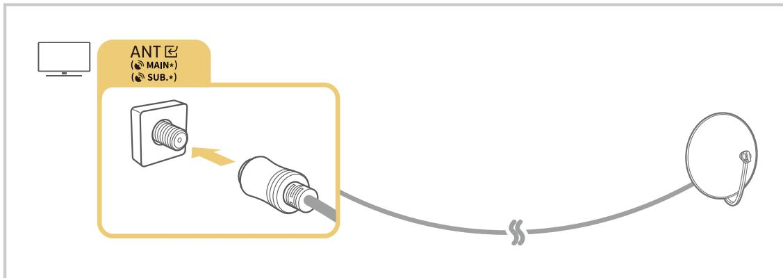
Найкраще під'єднувати обидва роз'єм за допомогою мультиперемикача, перемикача DiSEqC тощо і налаштовувати для **Тип підключення антени** параметр **Подвійне**.
