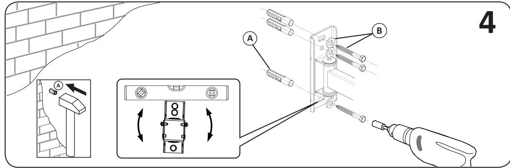
**Увага!** Після встановлення кронштейну перевіріти надійність його кріплення до стіни.
