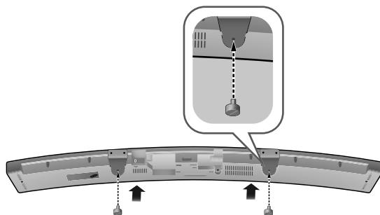
5. Установите и закрепите **Фиксатор опоры** в каждом отверстии снизу устройства. Устройство закреплено на **Настенный кронштейн**.
