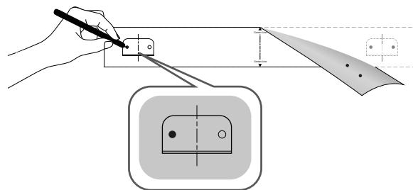
2. С помощью ручки отметьте расположение винтов на стене, затем уберите руководство. Просверлите отверстия под винты, используя сверло соответствующего размера.
