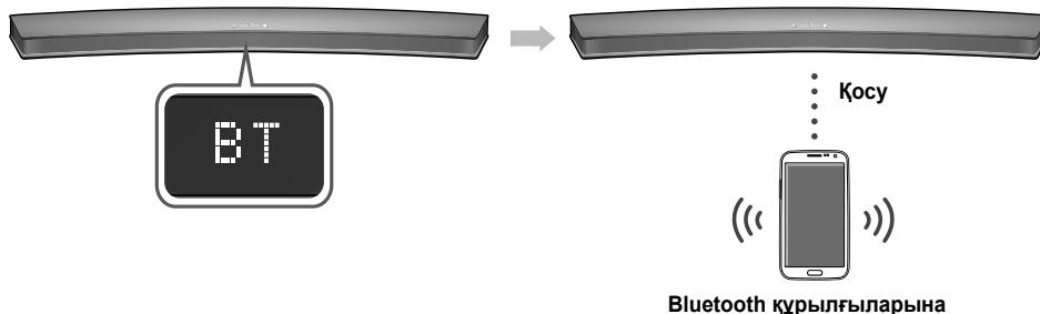
1. **BT** режимін таңдау үшін, негізгі құрылғының үстінгі панеліндегі → (Көз) түймесін немесе қашықтан басқару құралындағы **SOURCE** түймесін басыңыз.
