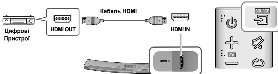
1. Під'єднайте кабель HDMI до розніму **HDMI IN** на задній панелі продукту і до розніму HDMI OUT на цифрових пристроях.
