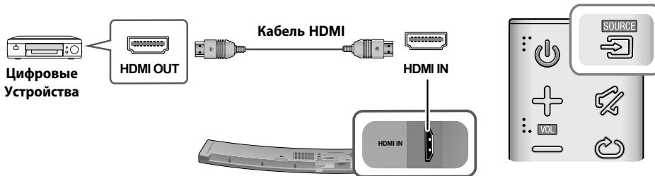
1. Подключите кабель HDMI в гнездо **HDMI IN** на задней панели устройства и гнездо HDMI OUT цифрового устройства.
