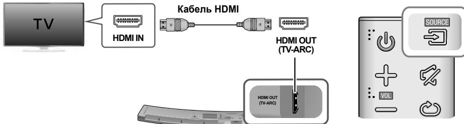
1. Під'єднайте один кінець кабелю HDMI до розніму **HDMI OUT (TV-ARC)** на задній панелі продукту, а інший – до розніму **HDMI IN** на телевізорі.
