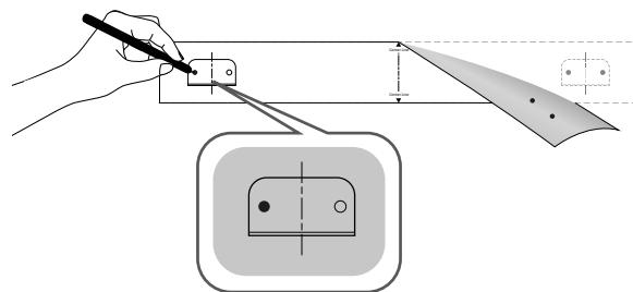
2. Позначте на стіні місце, куди необхідно вкрутити гвинти. Приберіть посібник з установлення. Потім за допомогою свердла відповідного розміру зробіть отвори для гвинтів.
