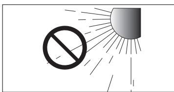
Не подвергайте устройство воздействию прямых солнечных лучей и других источников тепла. Это может вызвать перегрев и привести к неисправности устройства.
