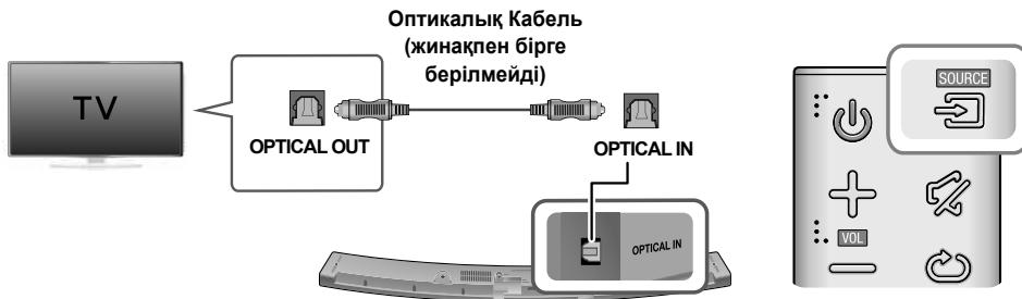
1. Soundbar құрылғысындағы **OPTICAL IN** (Дыбыс кірісі) портын теледидардың **OPTICAL OUT** ұсынына қосыңыз.
