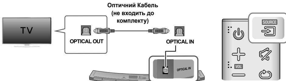
1. Під'єднайте рознім **OPTICAL IN** (Аудіо) пристрою Soundbar до гнізда **OPTICAL OUT** на телевізорі.
