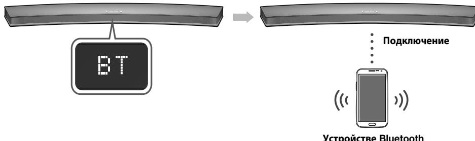
1. Нажмите кнопку (Источник) на верхней панели основного устройства или кнопку **SOURCE** на пульте дистанционного управления, чтобы выбрать режим **BT**.
