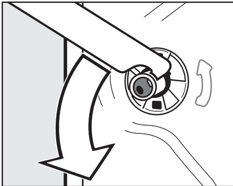
■ Поверните левый транспортиро-вочный стержень прилагаемым гаечным ключом на 90° и
