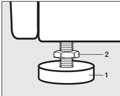
■ Отверните контргайку **2** с помощью прилагаемого гаечного ключа по часовой стрелке. Выверните контргайку **2** вместе с ножкой **1**.
