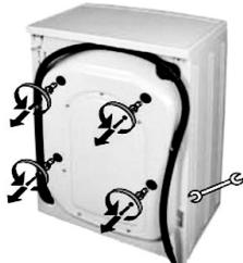
**!** Перед эксплуатацией стиральной машины выньте транспортировочные болты!
