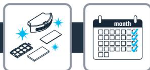
**UK** Після кожного використання необхідно спорожнити й очищувати робота. Натисніть кнопку на зворотному боці робота і витягніть пілозбірник. Відкиньте кришку, щоб спорожнити пілозбірник.
