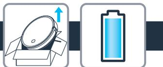
**BG** За да заредите робота, трябва да го включите, като натиснете копчето за вкл./изкл. за 3 секунди. Поставете робота върху докинг станцията: зареждащите плочи на робота трябва да докосват тези на докинг станцията. След всяко използване върнете робота на базата му за зареждане.
