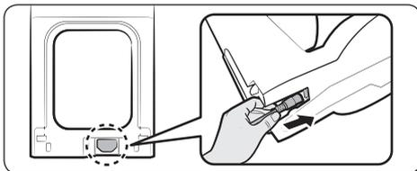
1 Підключіть кабель живлення, що йде в комплекті, до нижньої частини очищувальної станції.
