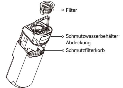
3. Gießen Sie das Schmutzwasser aus und entfernen Sie die festen Rückstände aus dem Schmutzfilterkorb. Spülen Sie mit sauberem Wasser nach. Reinigen Sie die Innenwände des Behälters mit der mitgelieferten Reinigungsbürste.
