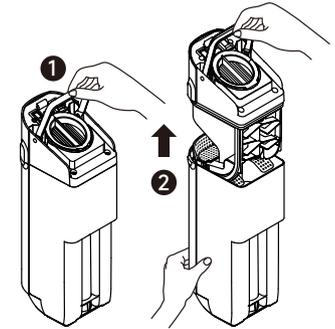
3. Gießen Sie das Schmutzwasser aus und entfernen Sie die festen Rückstände aus dem Schmutzfilterkorb.
