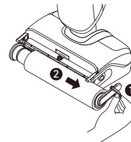
3. Entfernen Sie mit der mitgelieferten Reinigungsbürste alle auf der Walzenbürste befindlichen Haare und Verschmutzungen. Spülen Sie die Walzenbürste und die Abdeckung mit sauberem Wasser ab und trocknen Sie diese vollständig.
