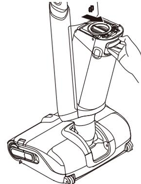
2. Ziehen Sie den Griff der Abdeckung des Schmutzwasserbehälters nach oben, heben Sie die Abdeckung an. Nehmen Sie den Filter heraus.
