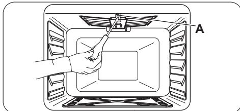
2. Выверните инжектор горелки с помощью торцевого ключа на 7 мм и замените его на инжектор подходящего типа.
