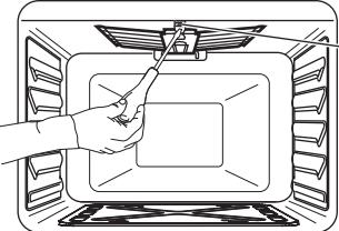
2. Відкрутіть форсунку конфорки торцевим ключем на 7 мм і замініть її.
