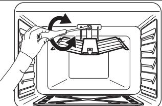
3. Зберіть конфорку, повторивши процедуру у зворотній послідовності. Перед закручуванням гвинта переконайтесь в тому, що пальник правильно встановлено на задній панелі.
