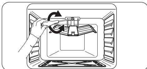
3. Соберите горелку, действуя в обратной последовательности. Прежде чем затянуть винт крепления убедитесь, что горелка правильно вставлена в заднюю панель.
