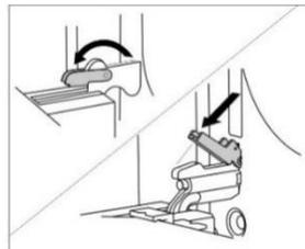
3. Повільно зачиняйте дверцята духовки, доки фіксатори не співпадуть із петлями на бокових планках дверцят. За кута 15° (відносно закритого положення) злегка прикрийте дверцята й витягніть їх з обох петель на приладі.
