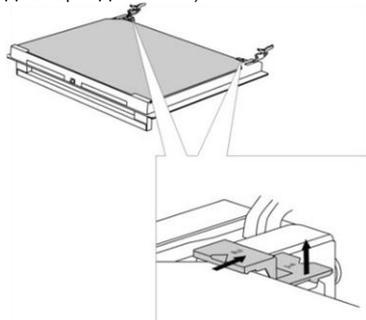
Трохи підніміть кріплення зліва і справа від дверцят (відмітка 1 на кріпленні) і витягніть їх зі скляної панелі (відмітка 2 на кріпленні).
