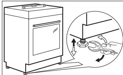
Для выравнивания по высоте верхней части прибора с другими поверхностями используйте маленькие ножки в нижней части прибора.
