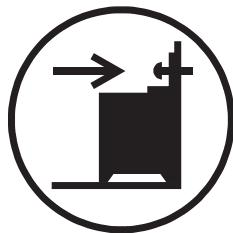
1. Установите защиту от опрокидывания на расстоянии В –343 мм вниз от верхнего края прибора и на А–67 мм от бокового края прибора в круглое отверстие на кронштейне. Привинтите его к прочному материалу или прикрепите с помощью соответствующей арматуры (к стене).
