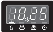
Выключить звуковой сигнал, который подается духовкой, можно прикоснувшись к любому из сенсоров панели управления , или . После выключения звукового сигнала, на дисплее отобразится текущее время.
