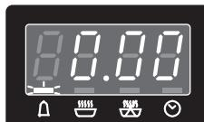
2. На протяжении 3-х секунд с помощью сенсоров и установите время, через которое духовка будет подавать звуковой сигнал (например: через 25 минут).
