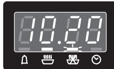
5. На протяжении 3-х секунд с помощью сенсоров и установите время, когда духовка должна закончить приготовление, и автоматически отключиться. (например: 11:00)
