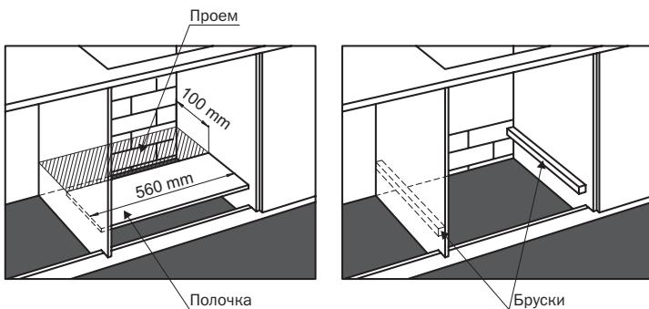
Поэтому очень важно при установке духового шкафа в мебельную нишу на сплошную (целую) полку – оставить заднюю стенку ниши максимально открытой. Для доступа воздуха в полке должен иметься проем (заштрихованная область) с размерами не менее 100 x 560 мм. То есть мебельную нишу нельзя «зашивать» полностью.
