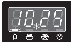
Вимкнути звуковий сигнал, що подається духовкою, можна доторкнувшись до будь-якого з сенсорів панелі управління , чи . Після вимкнення звукового сигналу, на дисплей відобразиться поточний час.
