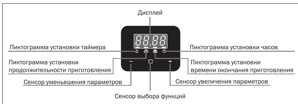
Сенсор предназначен для выбора функций программирования.
