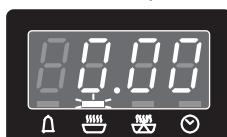
2. На протяжении 3-х секунд с помощью сенсоров и установите продолжительность приготовления. (например: 20 минут)
