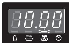
2. На протяжении 3-х секунд с помощью сенсоров и установите время, когда духовка должна закончить приготовление, и автоматически отключиться. (например: 10:20)
