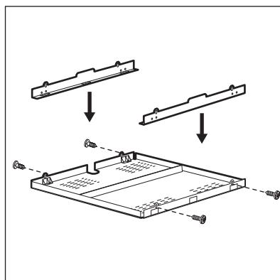
Če uporabljate zaščitno omarico (dodatekna oprema), zaščitno dno pod kuhalno ploščo ni potrebno. Zaščitna omarica morda ne bo na voljo v nekaterih državah. Obrnite se na krajevnega dobavitelja.
