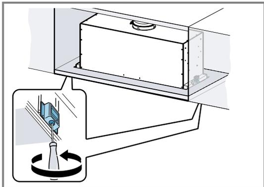
3. Вверните спереди оба винта в сделанные отверстия таким образом, чтобы поверхность прибора находилась на одном уровне с мебелью для встраивания.
