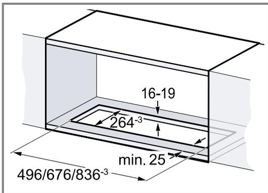
2. Сделайте вырез для вытяжной трубы либо над встроенной мебелью, либо за встроенной мебелью над прибором.
