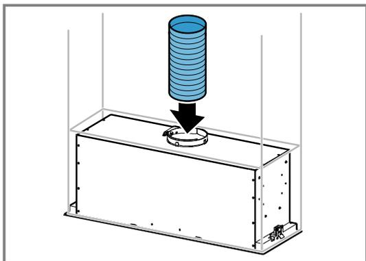
2. Подсоедините трубу к вытяжному отверстию.
