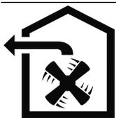
Воздух нельзя отводить в дымоход, используемый для вывода отработавших газов приборов, работающих на газе или других видах топлива (это не относится к устройствам с циркуляцией воздуха).
