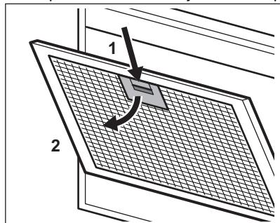
3. Incline ligeramente la parte delantera del filtro hacia abajo y tire de él.
