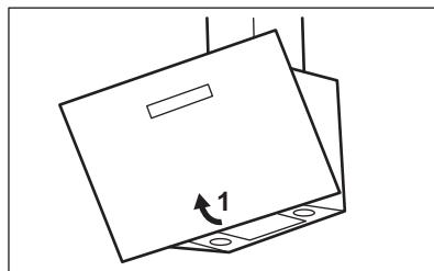
2. Druk op de handgreep van de montageclip op het filterpaneel onder de kap.
