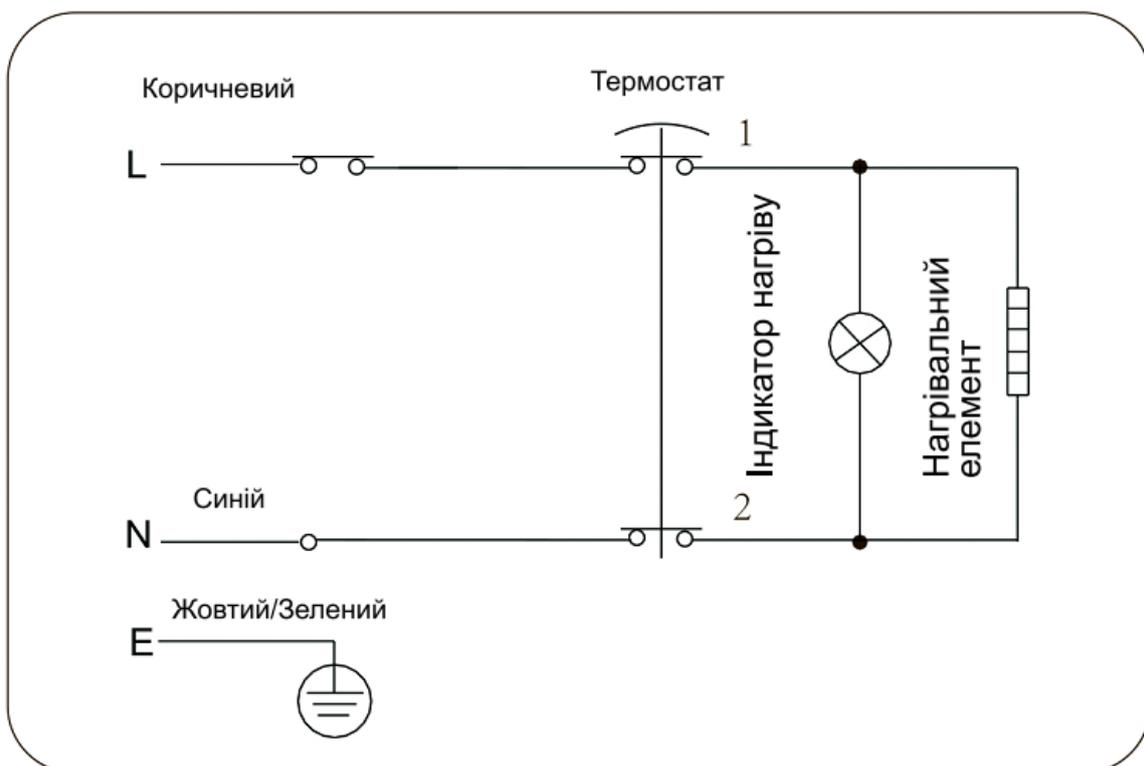
Водонагрівач розрахований на підключення до електромережі з одною фазою, напругою 230В, частотою 50 Гц.
