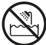
Dieses Symbol bedeutet, dass das Gerät nicht in der Nähe von Badewannen, Duschen, Waschbecken oder anderen Wasserbehältern verwendet werden darf.
