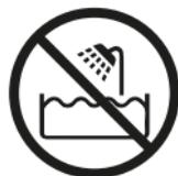
Ce symbole signifie que l'appareil ne doit pas être utilisé à proximité de baignoires, de douches, d'éviers ni de tout autre réservoir d'eau.
