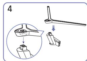
Вставте основу підставки в її кріплення в напрямку, указаному на малюнку. Перевірте, чи надійно під'єднано кріплення підставки.
