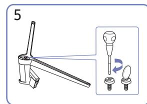
Поверніть гвинт для з'єднання внизу підставки до кінця так, щоб його було повністю зафіковано.
