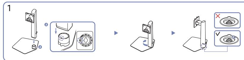
Перевірте напрямок, вказаний стрілкою на основі підставки. Сумістіть передню сторону кріплення підставки з основою підставки в напрямку стрілки, зазначеному на основі підставки, а потім вставте кріплення підставки зверху вниз.
