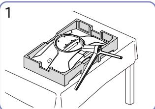
Помістіть захисний пінопласт (прокладку), що входить до комплекту, на підлогу та покладіть на нього виріб лицьово стороною вниз, як показано на зображенні. Якщо пінопласти немає, використовуйте товстий карімат.
