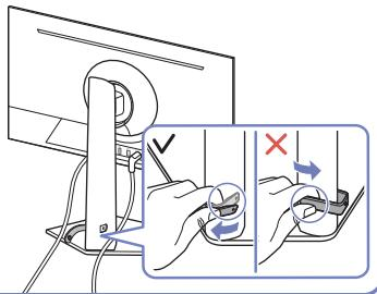
Потягніть за правий бік КРИПЛЕННЯ ДЛЯ КАБЕЛІВ НА ТРИМАЧІ ПІДСТАВКИ, щоб від'єднати від підставки. Якщо прикласти силу, можна пошкодити ліву сторону КРИПЛЕННЯ ДЛЯ КАБЕЛІВ НА ТРИМАЧІ ПІДСТАВКИ.
