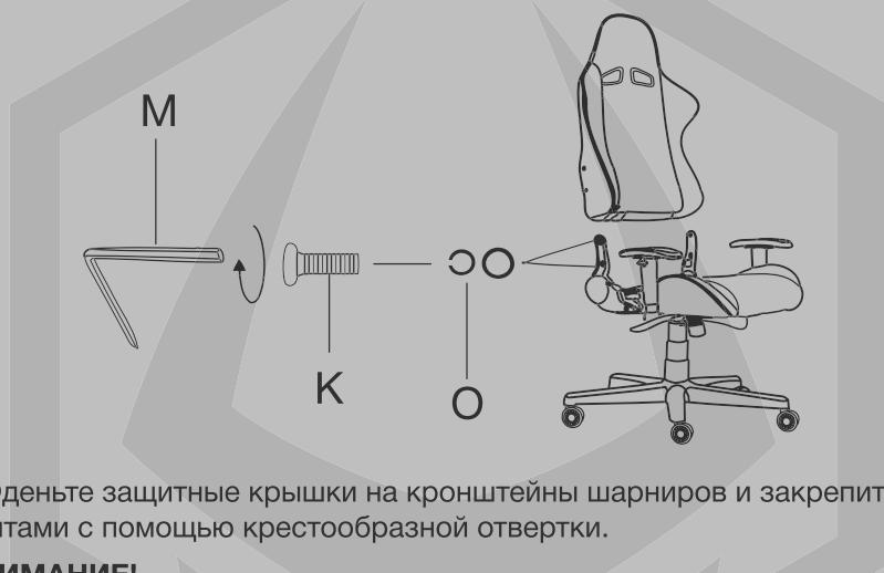
7. Оденьте защитные крышки на кронштейны шарниров и закрепите их винтами с помощью крестообразной отвертки.
