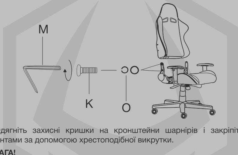
7. Одягніть захисні кришки на кронштейни шарнірів і закріпіть їх гвинтами за допомогою хрестоподібної викрутки.
