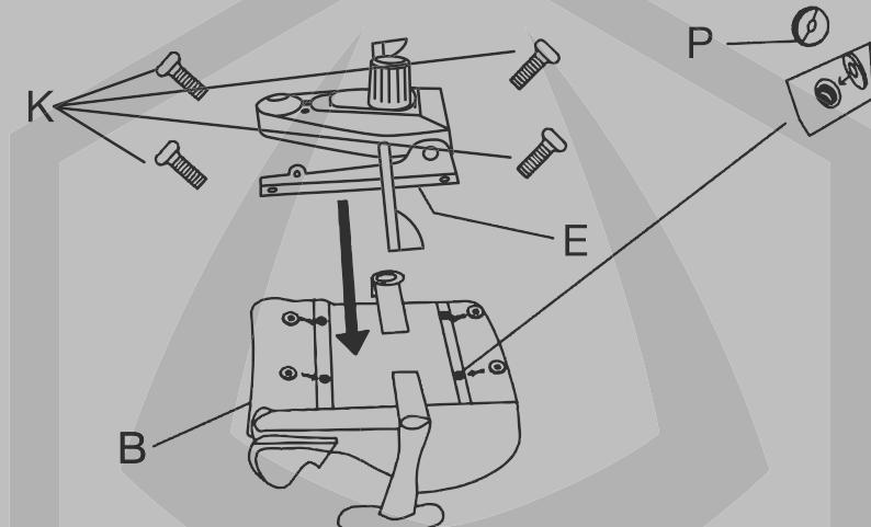
5. Поместите блок сидения на блок подставки кресла, вставив цилиндр пневматического подъемного механизма в центральное отверстие в основе сидения с механизмом регулирования.
