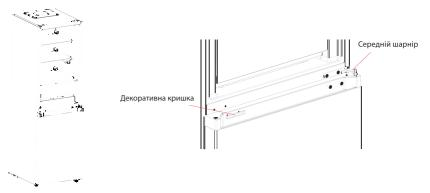
4) Зніміть дверцята морозильної камери, а також демонтуйте шарнір і відрегулюйте кут. Зніміть і встановіть вісь нижнього шарніра з іншого боку шарніра, і встановіть модифікований нижній шарнір з іншого боку корпусу.
