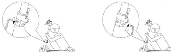
Wenn Sie der Meinung sind, dass die vordere Stange nicht fest genug ist, ziehen Sie die beiden Schrauben im Klappmechanismus mit dem Inbusschlüssel fest.
