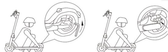
Jeśli uważasz, że hamulce są zbyt ciasne, użyj klucza sześciokątnego w kierunku przeciwnym do ruchu wskazówek zegara, aby poluzować śruby płyty dociskowej na gnieździe hamulca tarczowego. Zwolnij przewód hamulcowy, aby nieznacznie skrócić odsłoniętą długość i dokręcić śruby płyty dociskowej. Jeśli uważasz, że hamulec jest zbyt luźny, zwolnij śrubę na płytcie dociskowej, przeciągnij linkę hamulca, aby nieznacznie wydłużyć jej długość, a następnie zablokuj śrubę na płytcie dociskowej.
