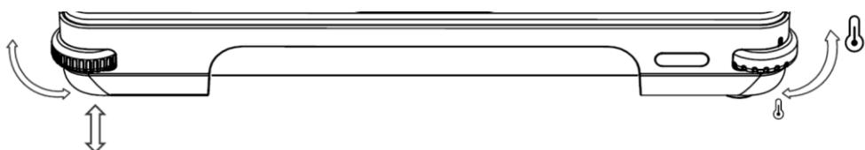
– Правым колесиком (Е) установите мощность нагрева. Для увеличения температуры вращайте колесико против часовой стрелки. Во время работы нагревательного элемента (D) светится красная лампочка-индикатор (F).
