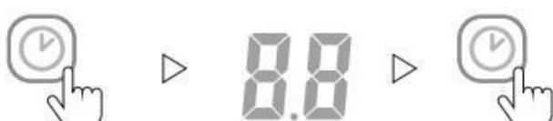
Натисніть кнопку «Таймер», індикатор синхронізації загориться зеленим, для встановлення необхідного часу роботи в межах 1-24 години, а потім натискайте кнопку «Таймер» до тих пір, поки не з'явиться 00. Після восьми сек на дисплей з'явиться поточна вологість і функція синхронізації буде відключена. Після закінчення заданого часу компресор зупиниться автоматично.
