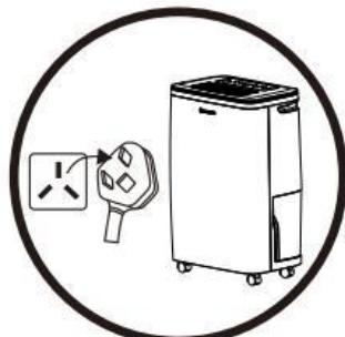
Не вимикайте осушувач висмикуванням шнура живлення. Відключення осушувача за допомогою вилки живлення може привести до ураження електричним струмом, пожежі і т. п. Завжди використовуйте панель управління, щоб зупинити роботу осушувача. Знеструмте осушувач, якщо він не використовується протягом тривалого часу. Накопичення пилу може привести до витоку, втрати тепла, пожежі і т. п. Знеструмте прилад, щоб уникнути ураження електричним струмом.
