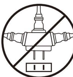
Забороняється замінювати шнур живлення або підключати кабель живлення через переходники паралельно. Несанкціонована заміна, проміжне з'єднання, перевантаження можуть привести до ураження електричним струмом або пожежі. Якщо шнур живлення пошкоджений, зверніться до місцевого дилера або в сервісну мережу для ремонту. Несанкціоновані розбирання, модифікація, ремонт або чищення внутрішніх компонентів заборонені.
