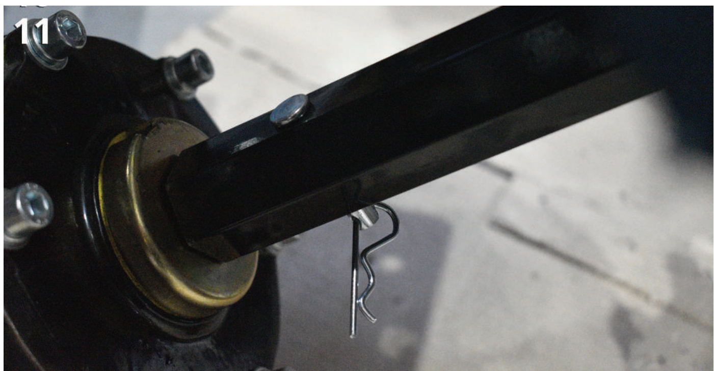
Мал.11. Фіксуємо напіввісь колеса до вісі редуктороа за допомогою стопорного пальця та шплінта.
