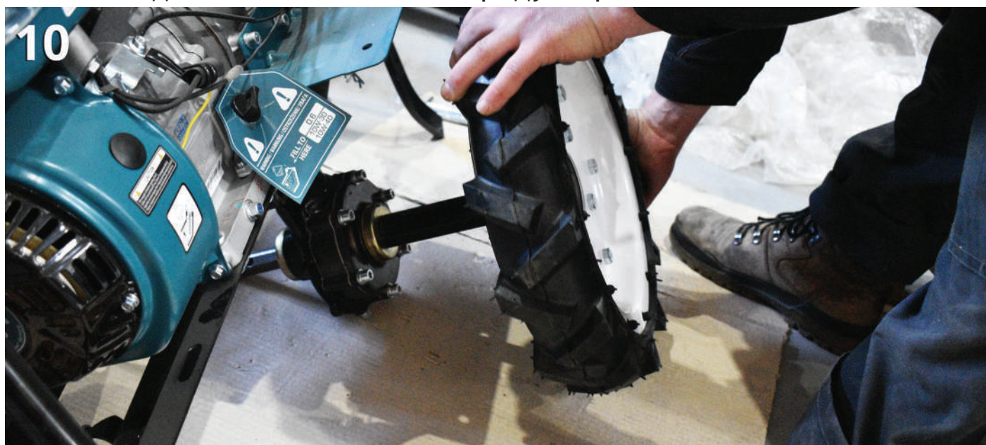
Мал.11. Фіксуємо напіввісь колеса до вісі редуктороа за допомогою стопорного пальця та шплінта.
